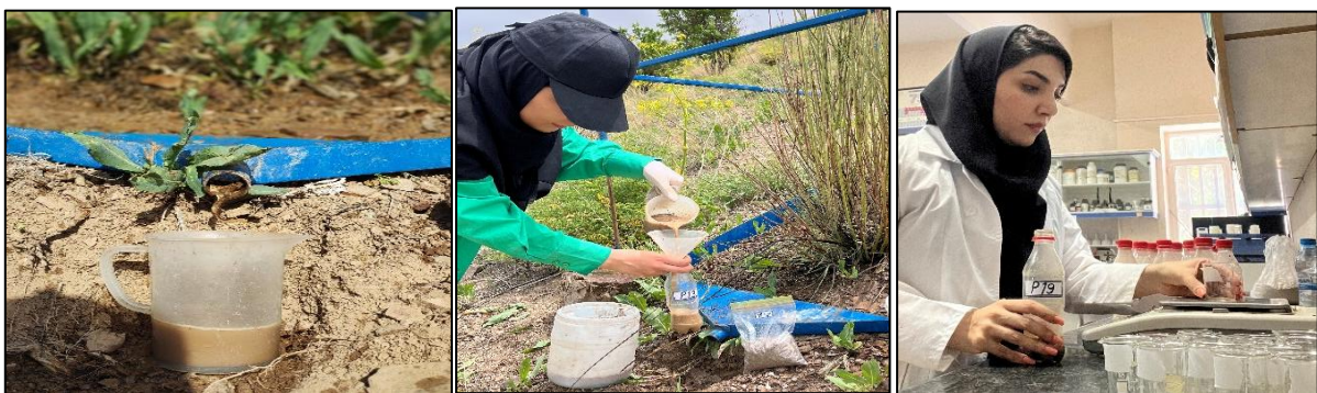
شکل ۶: تصاویری از برداشت رواناب ایجادشده پس از بارش (راست و وسط) و اندازه‌گیری‌های وزن رسوبات در آزمایشگاه (چپ)
