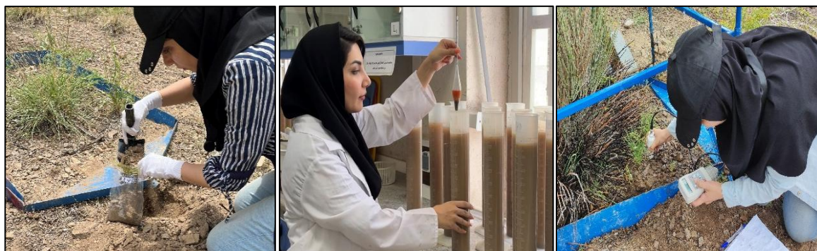
شکل ۵. تصاویری از اندازه‌گیری رطوبت خاک با دستگاه TDR (راست)، برداشت نمونه خاک برای آزمایش بافت خاک (وسط) و اندازه‌گیری‌های بافت خاک در آزمایشگاه (چپ)
