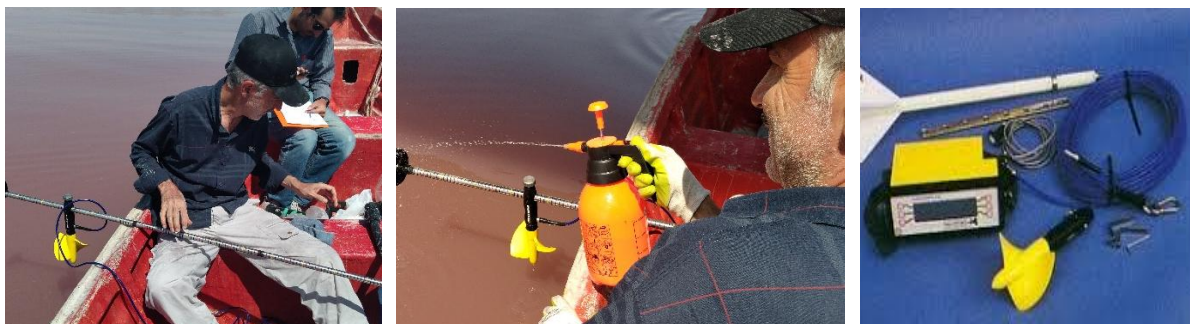
شکل ۲. به کارگیری دستگاه جریان‌سنج BFM-001 در سنجش سرعت جریان در دهانه‌های ۱۷ گانه میان گذر پل شهید کلانتری
