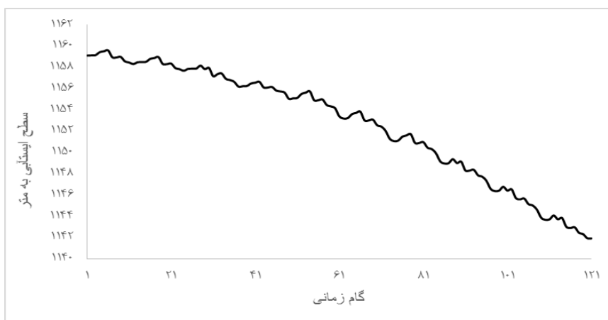
شکل ۹. وضعیت سطح آب زیرزمینی در صورت افزایش سالیانهٔ ۱/۵ درصد بهره‌برداری نسبت به حالت فعلی بهره‌برداری برای ۱۲۱ گام زمانی
