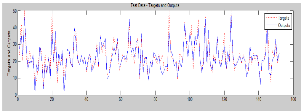
شکل ۸. مقایسه تبخیر شبیه‌سازی شده با استفاده از مدل ANFIS و تست تبخیر در مرحله TEST
