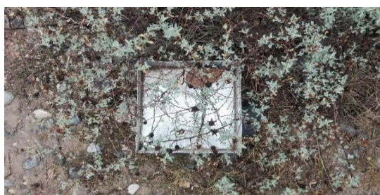
شکل ۱. ظروف اندازه‌گیری مقدار بارش در زیر بوته‌ها در تعدادی از تکرارهای درمنه جارویی در فروردین‌ماه
