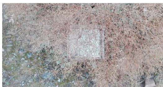
شکل ۱. ظروف اندازه‌گیری مقدار بارش در زیر بوته‌ها در تعدادی از تکرارهای درمنه جارویی در فروردین‌ماه
