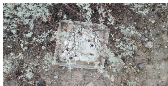
شکل ۱. ظروف اندازه‌گیری مقدار بارش در زیر بوته‌ها در تعدادی از تکرارهای درمنه جارویی در فروردین‌ماه
