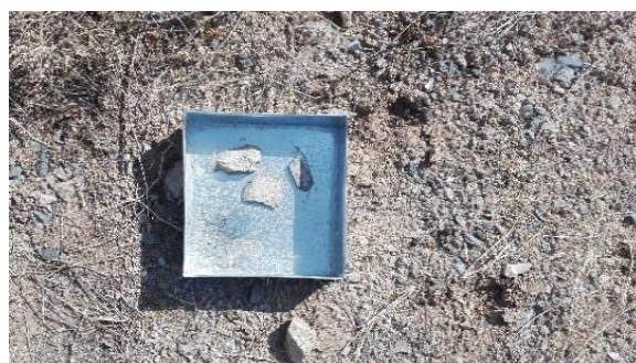
شکل ۴. ظروف شاهد برای اندازه‌گیری بارش در منطقه مطالعه‌شده (بدون وجود پوشش گیاهی)
