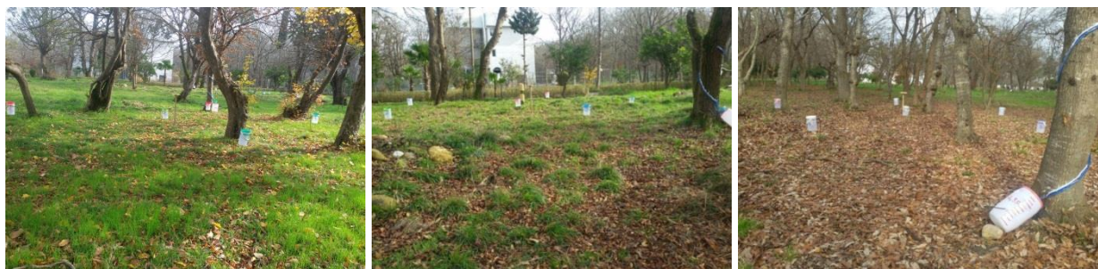
شکل ۲. نمایی از شیوه اندازه‌گیری میان‌گذر و نصب ظروف جمع‌آوری نمونه در تیپ‌های مطالعاتی بلوط (راست)، اوجا (وسط) و انجیلی (چپ)
