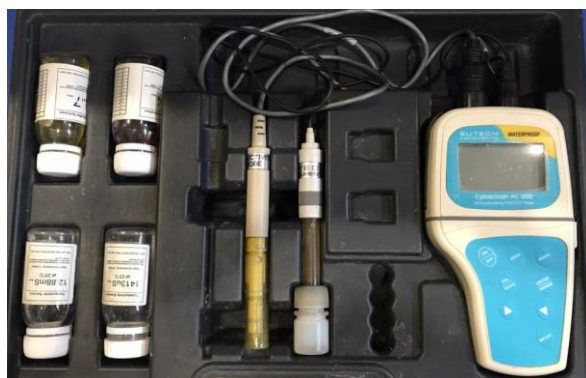
شکل ۲. دستگاه پرتابل اندازه‌گیری فاکتورهای pH، EC (هدایت الکتریکی)، TDS (کل مواد جامد محلول) و دما
