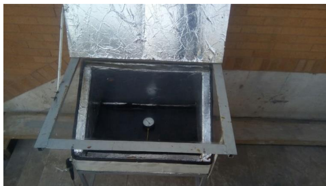
شکل ۱۰. محل استقرار دماسنج درون اجاق خورشیدی جعبه‌بزرگ
