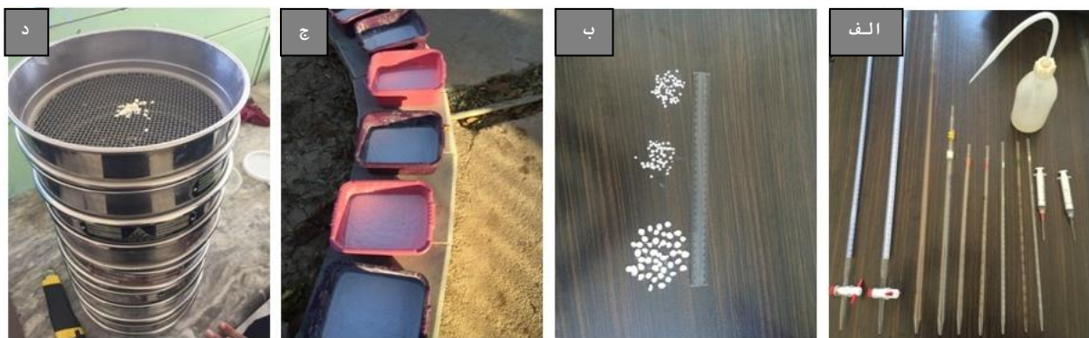
شکل ۲. اندازه‌گیری قطر قطرات باران به ترتیب مراحل الف) قطره‌سازها؛ ب) گلوله آردی ایجادشده با قطره‌سازها؛ ج) ظروف آرد استفاده‌شده در باران شبیه‌سازی شده و د) تفکیک گلوله‌های آردی با استفاده از سری الک‌های خاک‌شناسی
