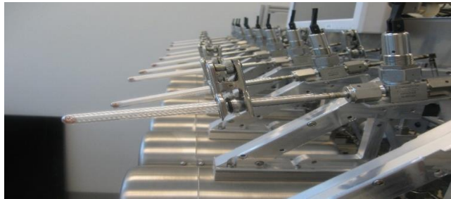
شکل ۳. ماشین تهیه کربن عنصری از دی‌اکسید کربن
