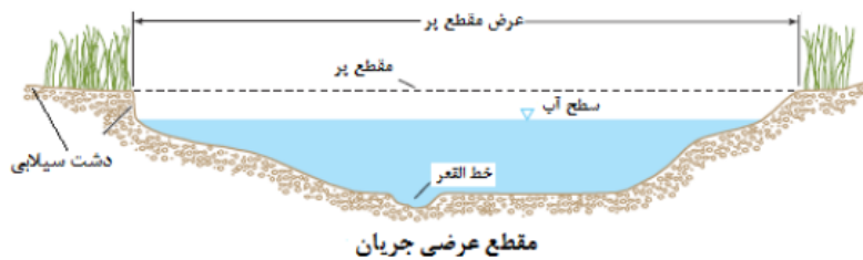
شکل ۲. نمایی از روش اندازه‌گیری دبی لبالی (به روش Lawlor) [۱۲]
