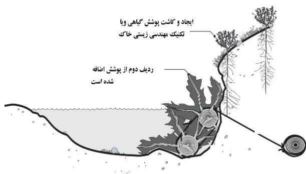
شکل ۲۰. نمایی از روش مهندسی زیستی Tree and Log Revetment
